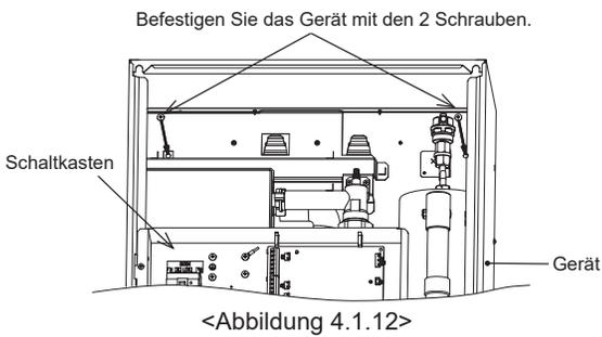
VORSICHT: Achten Sie, BEVOR Sie die Anlagenverrohrung durchführen, darauf, dass diese zwei Schrauben montiert und fest angezogen sind. Andernfalls könnte der Haken sich lösen und die Einheit herabfallen.
