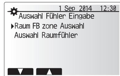
2. Wenn die Temperaturregelung für 2 Heizkreise aktiv ist und Funkfernbedienungen vorhanden sind, wählen Sie im Auswahlfenster Raum-FB-Zonenauswahl die Heizkreisnummer, die den einzelnen Fernbedienungen zugewiesen werden soll.
